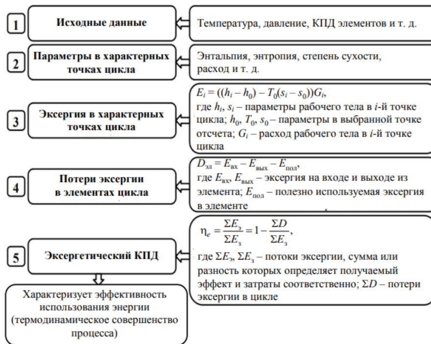
Рисунок 1.9 Структура математической модели для проведения эксергетического анализа схем на органическом цикле Ренкина
