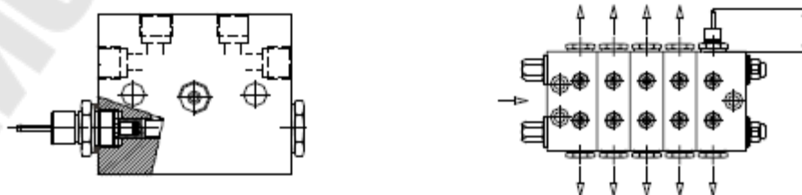
Рис.3.6 – Схема последовательного питателя с визуальным индикатором
