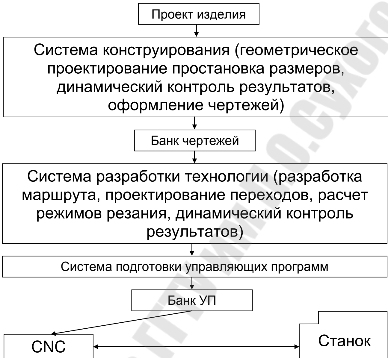
Рис. 1.3. Схема структуры интегрированной системы подготовки производства механической обработки
