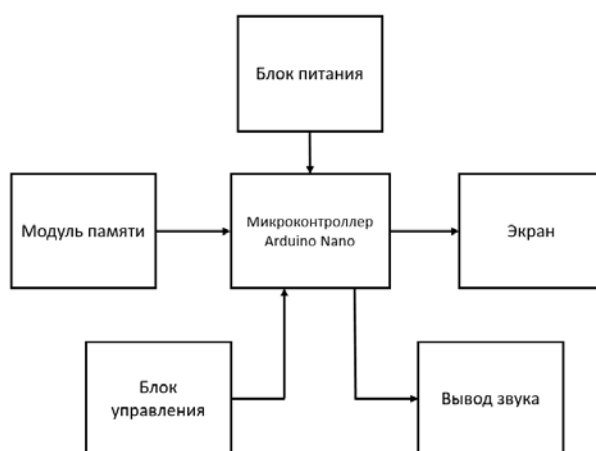
Рис. 1. Структурная схема технических средств таблетницы
