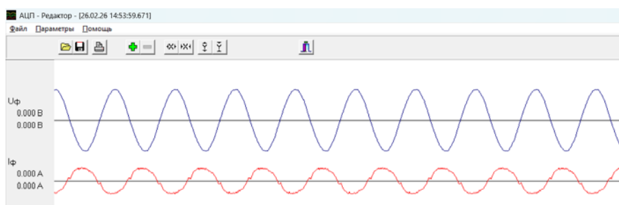
Рис. 1. Осциллограммы напряжений и токов при работе светильника серии ЛПП
