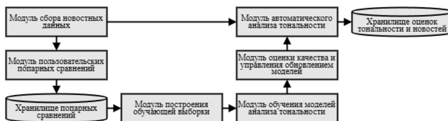
Рис. 1. Архитектура программного комплекса потокового анализа тональности финансовых новостей
