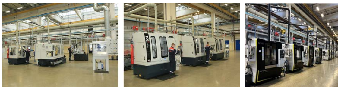
Рис. 10. Участок по изготовлению монолитного твердосплавного инструмента
