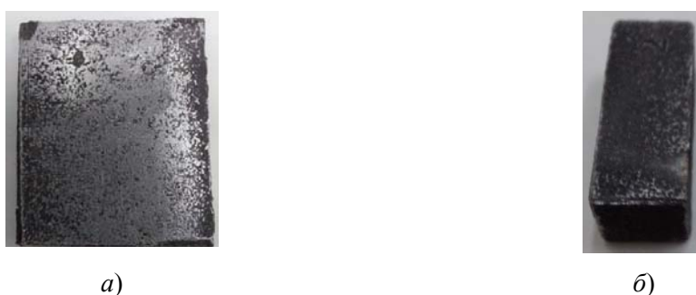
Рис. 1. Внешний вид поверхности образца из стали У8 после высокотемпературного алитирования (а) и окисления (б)
