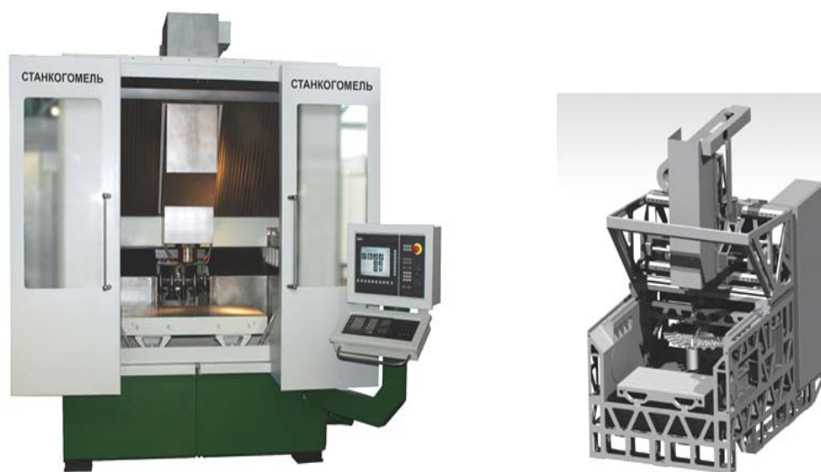
Рис. 1. Вертикальный обрабатывающий центр для трехсторонней обработки SGV1200-3X
