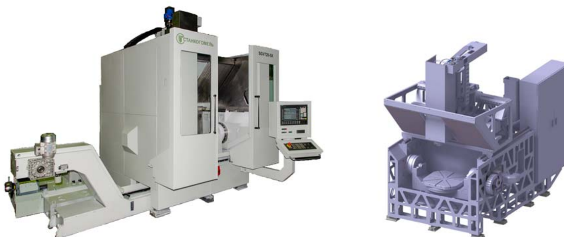
Рис. 2. Вертикальный обрабатывающий центр для пятисторонней обработки SGV720-5X
