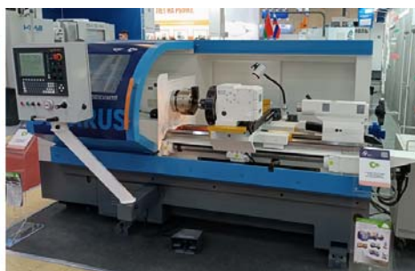
Рис. 2. Станок токарный с ЧПУ модели 16ГС25Ф3С4ГАКТП1
