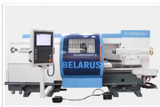
Рис. 3. Станок токарный с ЧПУ модели 16ГС40Ф3С5Г9НАТП1-01
