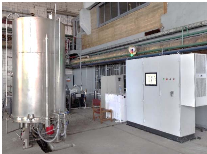
Рис. 2. Установка ионного азотирования производства ФТИ НАН Беларуси
