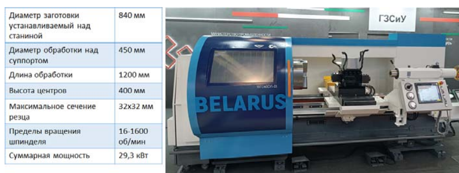
Рис. 5. Станок токарный с ЧПУ модели 16ГС40СУ1-01
