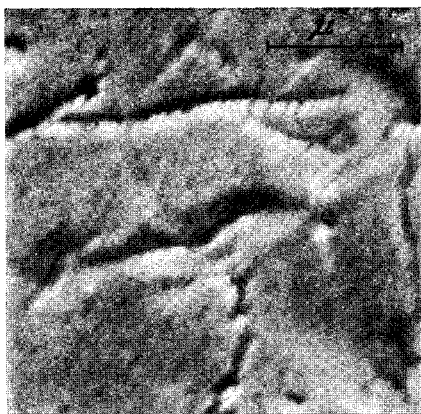
Рис. 1. Электронномикроскопические фотографии угля пласта «Мазур», \times 20000 Видны сообщающиеся переходные поры. a, б — пачка № 5; в, з — пачка № 2
