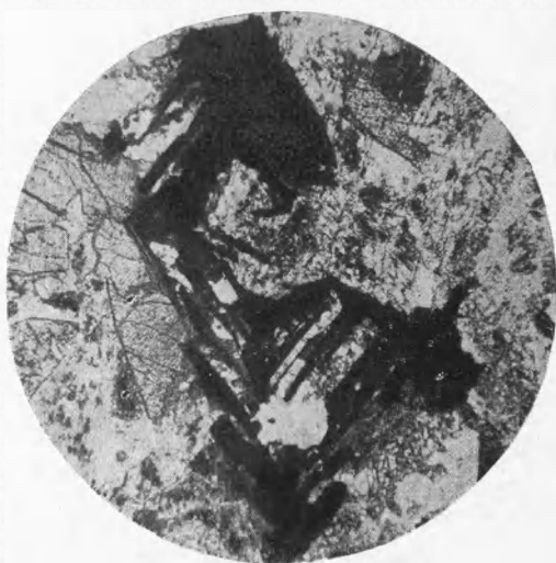
Рис. 2. Выделения титаномагнетита в диабазе восточной части Татарской АССР; \times 40
