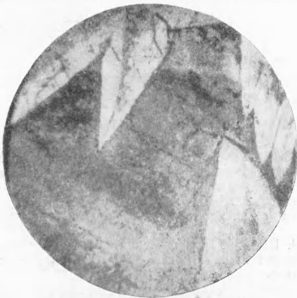
Рис. 2. Шлиф карбонато-гипсовой породы. Видны кристаллы глауберита, внедрившиеся при своем росте в тонкозернистую массу гипса и захватившие частицы гипса
