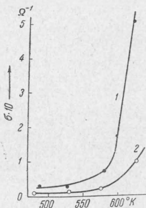
Рис. 3. Изменение проводимости ZnO с температурой в зоне реакции. 1 — в чистом азоте; 2 — в смеси газов ( N_2 + 0,4\% O_2 )
