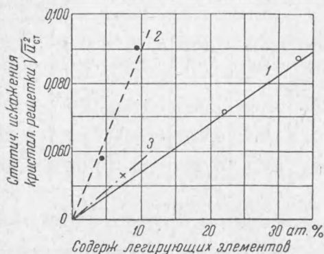
Рис. 3. Зависимость статических искажений кристаллической решетки от содержания легирующих элементов. 1 — Сг, 2 — Ti, 3 — Al
