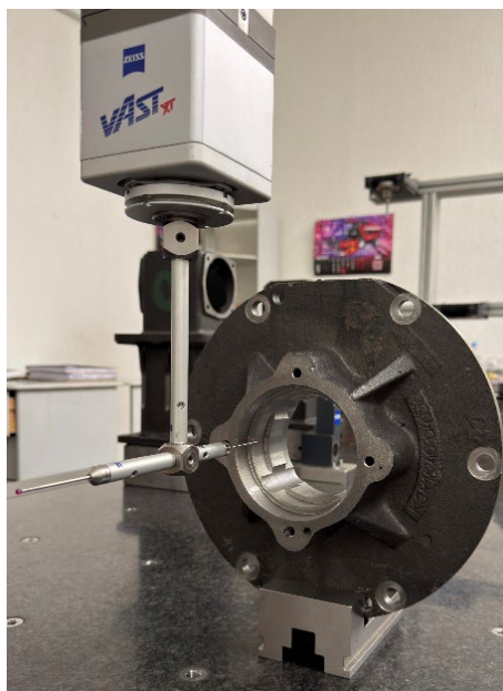
Рис. 6. Рабочая деталь при измерении на координатно-измерительной машине
