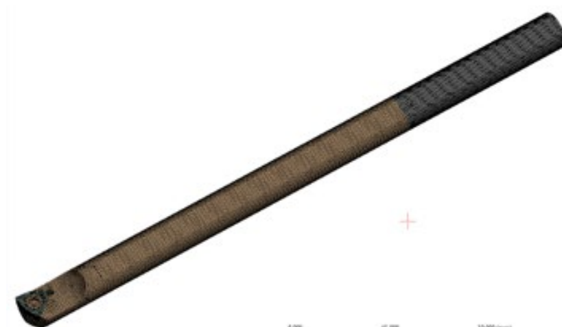
Рис. 3. Конечно-элементная модель сборного расточного резца
