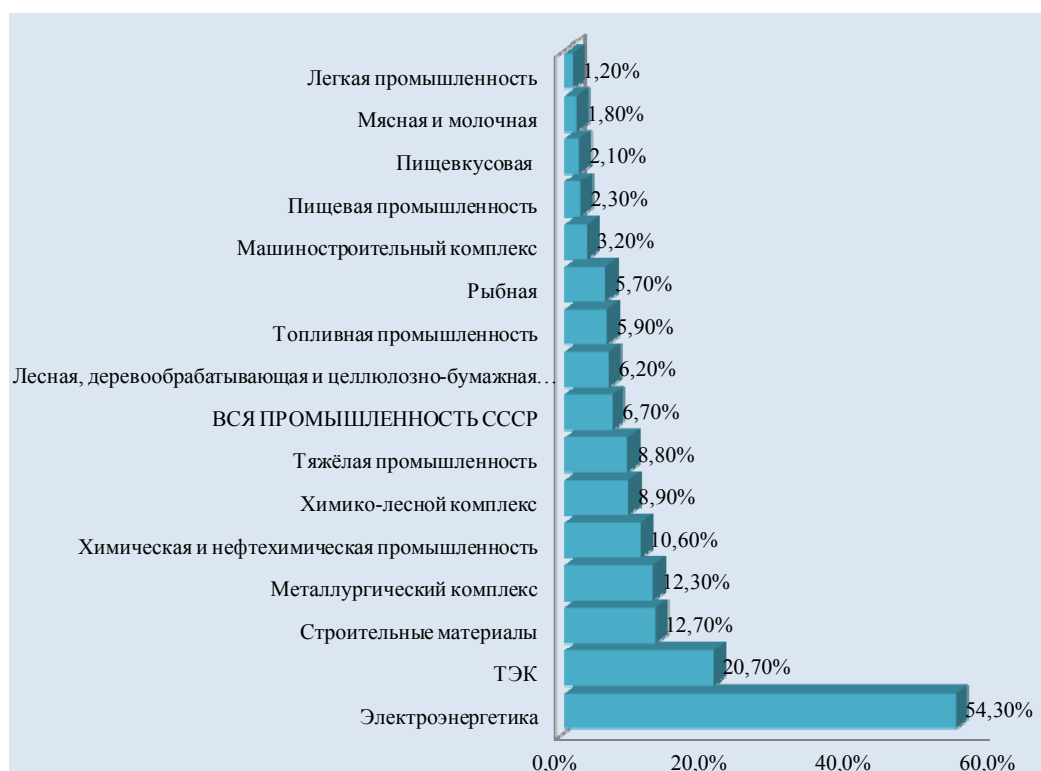
Рис. 1. Ранжирование энергетической составляющей затрат в себестоимости продукции по отраслям промышленности СССР (1987 г.)
