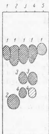
Рис. 2. Хроматограмма опыта с эфиром тирозина. Время инкубации 4 часа, температура инкубации 25°, рН 9. 1 — тирозин; 2 — эфир тирозина; 3 — пептид тирозина (1); 4 — пептид тирозина (2)
