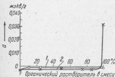
Рис. 2. Адсорбция HCl платинированным водородным углем из смесей органических растворителей с водой (уголь Б). C_0 = 10 мэкв/л. 1 — C_2H_5OH - H_2O ; 2 — CH_3COCH_3 - H_2O
