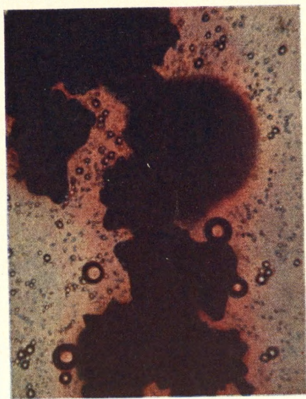
Рис. 2. Микрофотографии зерен угля, закрепившихся на поверхности воды, после контакта с эмульсией аполярного реагента (окрашенного в красный цвет). a, в — \times 500 ; б — \times 300
