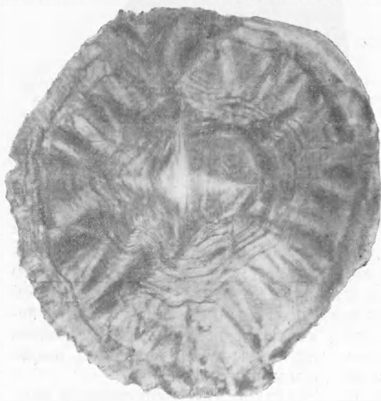
Рис. 2. Структура графитного включения после деформирования. \times 800
