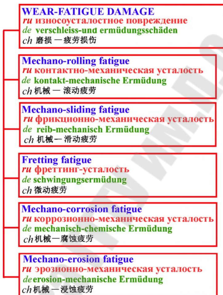
Рисунок 3.3 – Классификация основных видов износоусталостного повреждения согласно ГОСТ 30638-99
