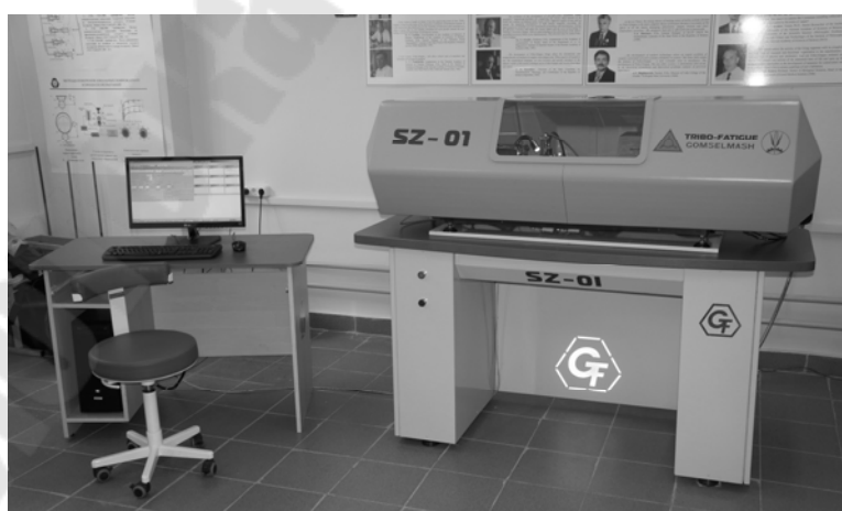
Рисунок 5.1 – Общий вид стенда для износоусталостных испытаний SZ-01
