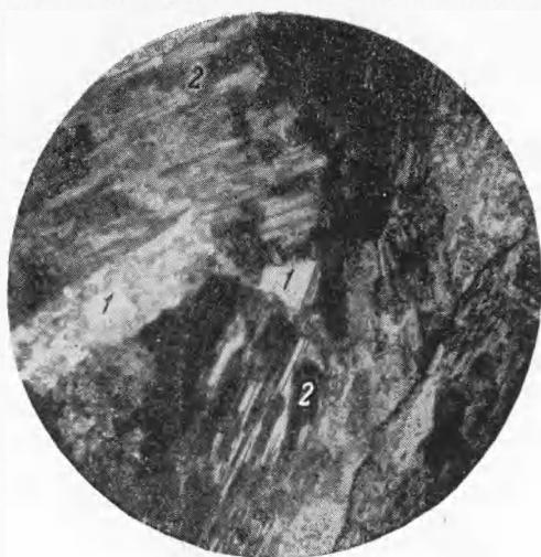
Рис. 3. Замещение плагиоклаза (1) калиевым полевым шпатом (2). Сиеенит, г. Высокая. \times 35 . Ник. +
