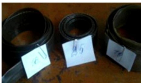
Рисунок 5 – Опытные образцы полимерной ленты с содержанием антипирена 0; 2 и 5% от массы
