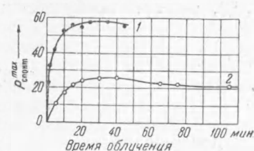
Рис. 2. Рост «спонтанной» поляризации по мере развития фотохимического процесса. 1 — \text{CaF}_2 , [100] , \varphi = 0 ; 2 — \text{NaF} , [100] , \varphi = \pi/4
