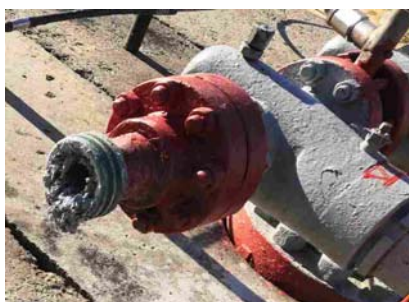
Рис. 1а. Голубоватый осадок на элементах оборудования скважины, где осуществлялась подача в товарной форме фосфонатного ингибитора солеотложений в затрубное пространство (фотография внутренней полости демонтированной затрубной задвижки)
