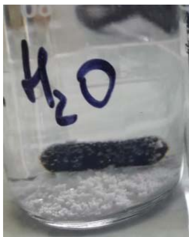
Рис. 2а. Кристаллизация галита в дистиллированной воде, насыщенной NaCl
