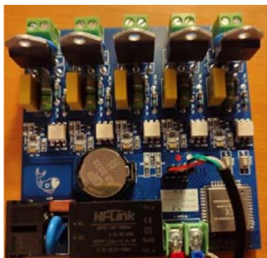
Рис. 1. Устройство «Умная школа на микроконтроллере ESP32 с возможностью управления удаленно»
