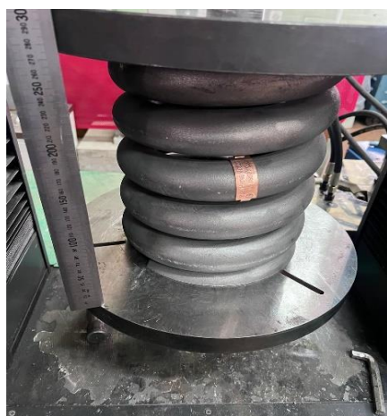
Рисунок 4 – Испытание пружины на испытательной машине TIME WDW-300 E при проверке высоты пружины под расчётной статической нагрузкой
