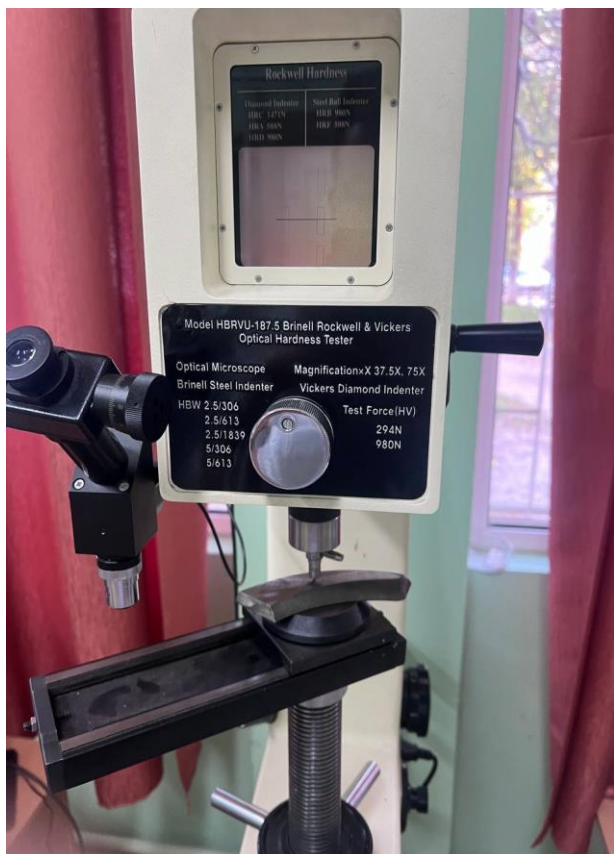
Рисунок 7 – Проведение испытаний на твердость пружины с использованием твердомера стационарного (HBRVU-187.5) Integral-5
