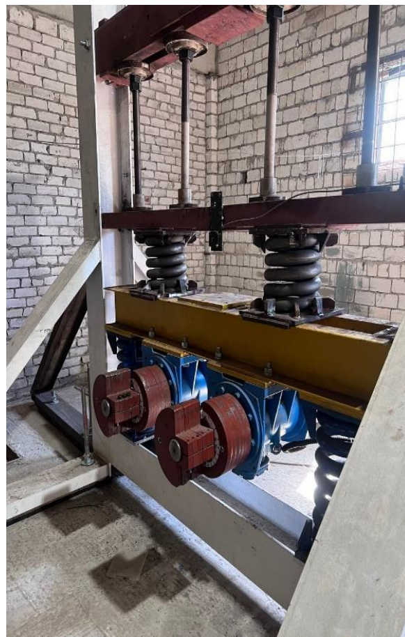
Рисунок 8 – Проведение испытаний на циклическую долговечность с использованием стенда для испытаний листовых рессор и пружин СП-2
