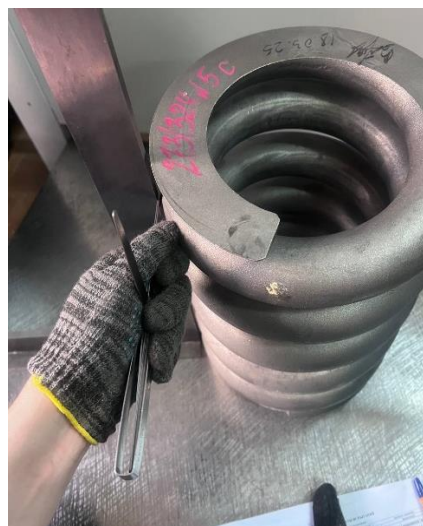
Рисунок 6 – Проведение измерений допуска перпендикулярности оси пружины на поверочной плите поверочной и разметочной, тип № 1-2-1000×630
