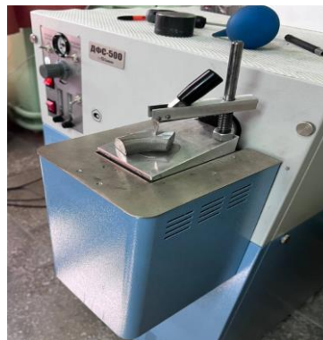
Рисунок 1 – Определение химического состава при помощи спектрометра ДФС-500
