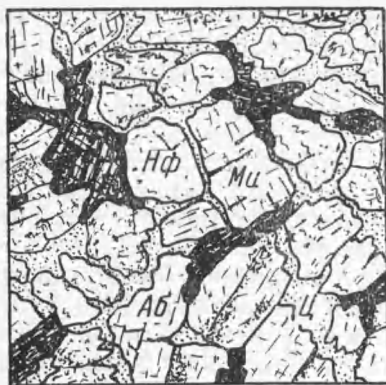
Рис. 1. Развитие процесса цеолитизации алюмосиликатов щелочной породы по трещинкам и границам зерен; \times 30
