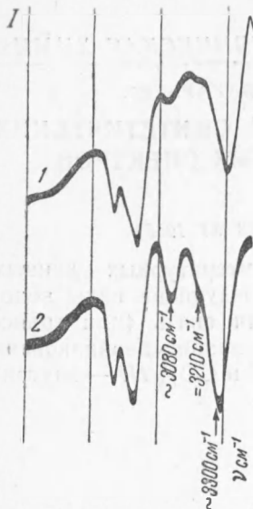
Рис. 1. Инфракрасные спектры поглощения поликапролактама. 1 — расплавленная пленка поликапролактама \sim 50 \mu , полученная нагреванием до \sim 220^\circ ; 2 — матовая пленка поликапролактама \sim 50 \mu , полученная осаждением из раствора в HCl
