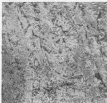
Рис. 1. Электронная микрофотография структуры полоски Кравз-Тарнавского; \times 5000
