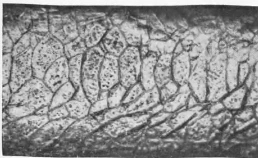
Рис. 1. Макромозаичная структура монокристалла алюминия технической чистоты после полигонизации. Электролитическая полировка после дополнительного отжига 400^{\circ} 1 час. \times 86
