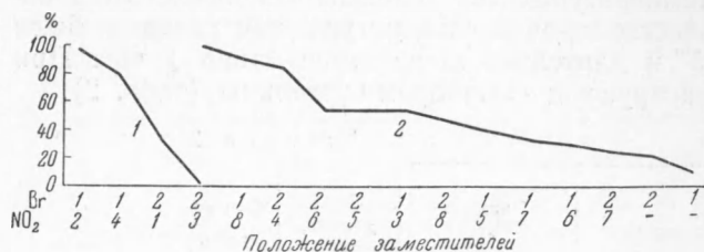
Рис. 3. Процент превращения при нагревании в течение 1 часа: 1 — с пиперидином при 50°, 2 — с пиперидином медным купоросом при 125°.
