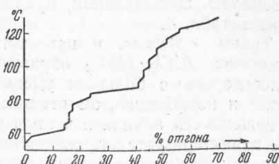
Рис. 3. Кривая разгонки продукта, полученного при реакции i-C_3H_7Cl с i-C_5H_{12} . Катализатор AlCl_3 \cdot HSO_4
