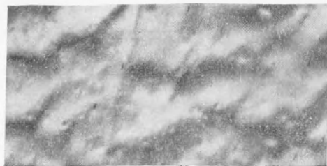
Рис. 2. Поверхность палладиевой пластинки после прогрева при 1000° в вакууме. a — слоистость уступов; б — межкристаллитная граница
