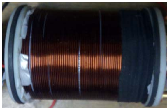
Мал. 2. Каркас шпулі індуктара (а), знешні выгляд індуктара пасля намоткі (б)
