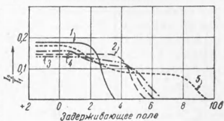
Рис. 3. Кривые задержки для никеля при различных значениях V_p . 1—2,8 в; 2—4,5 в; 3—5,0 в; 4—5,5 в; 5—8,8 в
