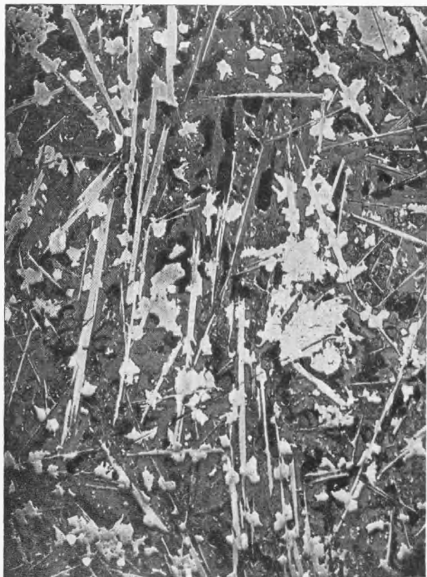
Рис. 1. Микроструктура шлака № 1756. Светлосерые пластинки и удлиненные зерна хромита кальция, белые округлые зерна металла, темносерый — силикат, черное — поры. Отраженный свет, \times 76
