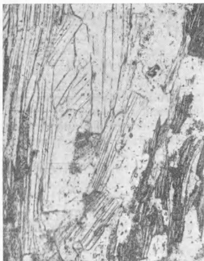
Рис. 3. Двуслюдяной парагнейс из буровой скважины у Новохоперска. Зерна биотита как бы обрамляют мусковит, изредка попадаются иголки силлиманита; \times 40
