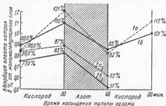
Рис. 3. Обратимость адсорбции олеата натрия в зависимости от переменного воздействия кислорода и азота на флюорит (1) и кварц (2). Рассчитано: а — на поверхность, обработанную газами и собирателем; б — на первоначальную поверхность
