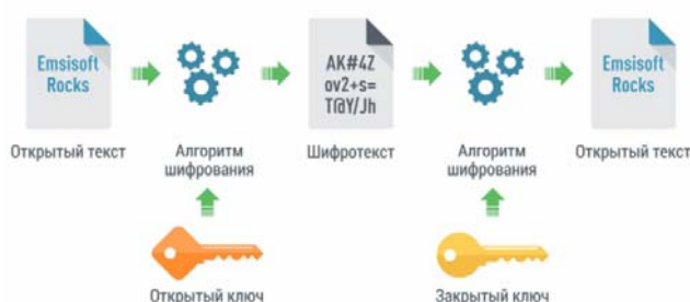
Рис. 2. Схема асимметричного алгоритма шифрования
