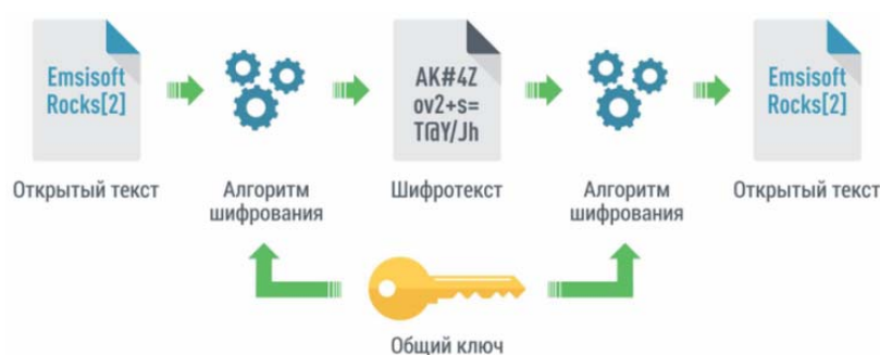
Рис. 1. Схема симметричного алгоритма шифрования
