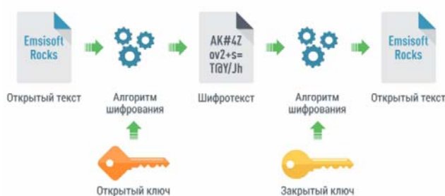
Рис. 2. Схема асимметричного алгоритма шифрования
