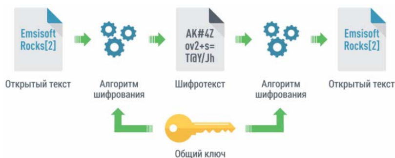
Рис. 1. Схема симметричного алгоритма шифрования
