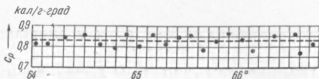
Рис. 2. Теплоемкость в зависимости от температуры (34 вес. % фенола)
