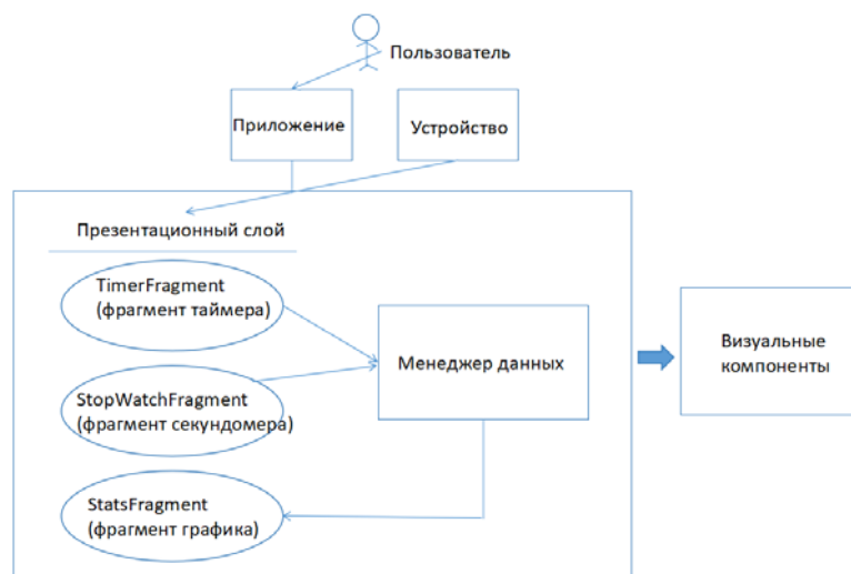
Рис. 1. Общая схема работы программно-аппаратного комплекса
