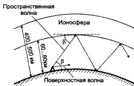
Рис. 10. Механизм распространения радиоволн
