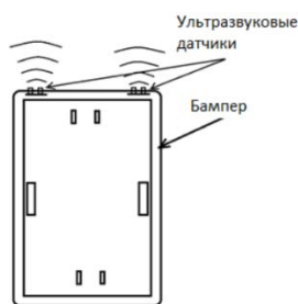
Рис. 2. Схема тележки с ультразвуковыми датчиками
