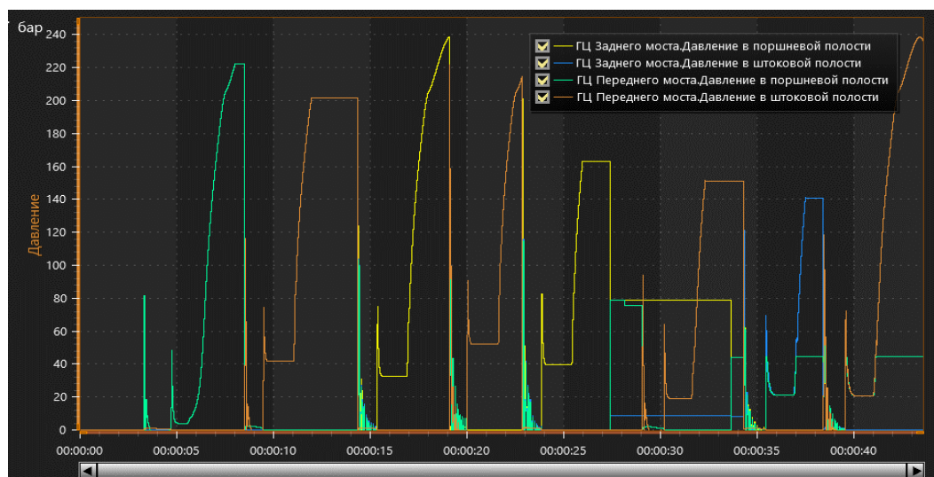
Рис. 2. График изменения давления гидроцилиндров
