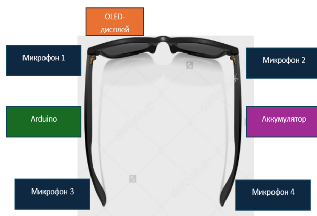
Рис. 1. Ключевые аппаратные элементы умных очков
