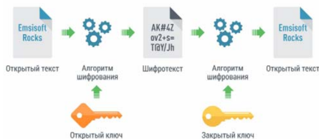
Рис. 2. Схема асимметричного алгоритма шифрования
