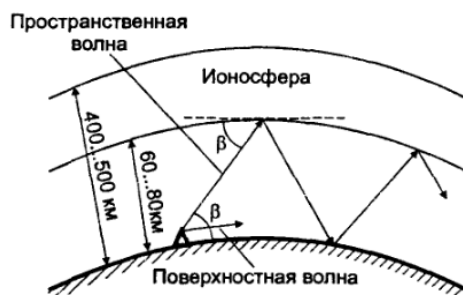
Рис. 10. Механизм распространения радиоволн
