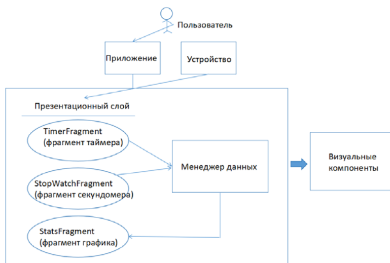
Рис. 1. Общая схема работы программно-аппаратного комплекса
