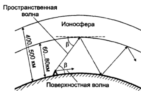
Рис. 10. Механизм распространения радиоволн
