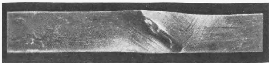
Рис. 1. Образец, деформированный при 20^{\circ} со скоростью 24% в час; \times 10
